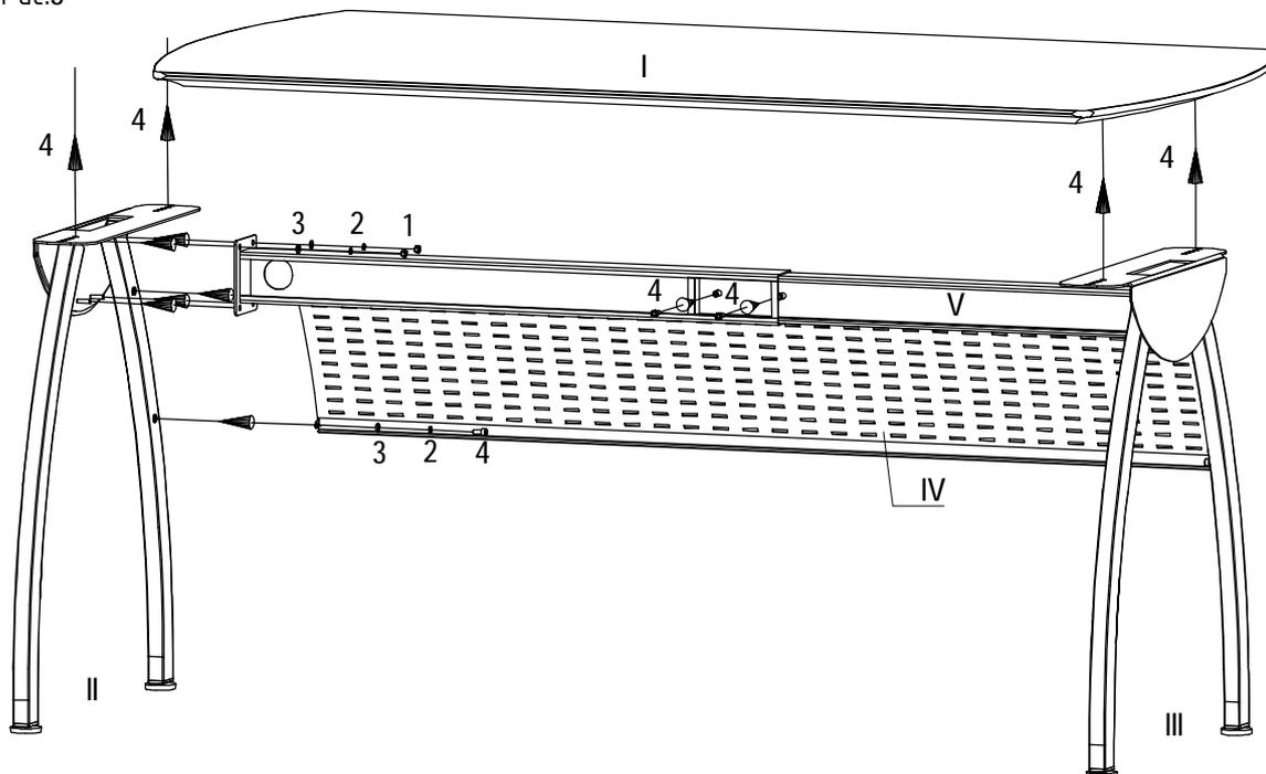
1. С помощью ключа (6) ослабить 2 фиксирующих винта (4) на балке соединительной (V).
