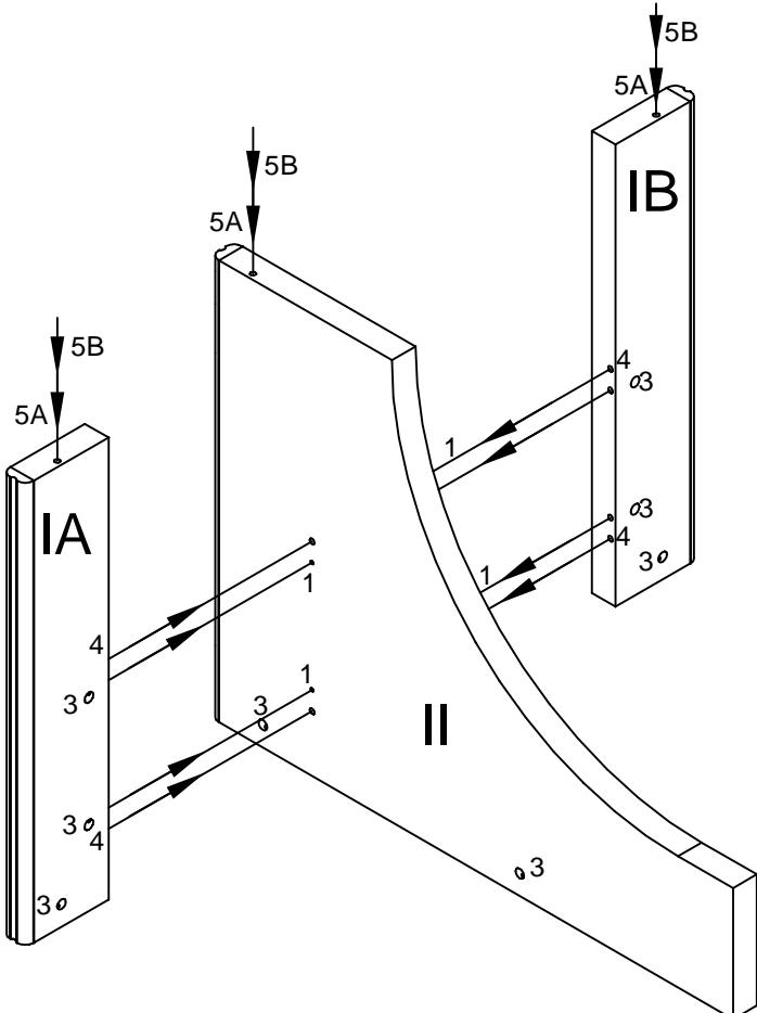
В боковины (I) забить шканты (4), вставить стяжки-эксцентрики (3). В среднюю панель (II) вкрутить дюбеля для стяжек-эксцентриков (1), вставить стяжки-эксцентрики (3). В боковины и среднюю панель забить крепёж опоры (5А) и ввернуть опоры (5В).
