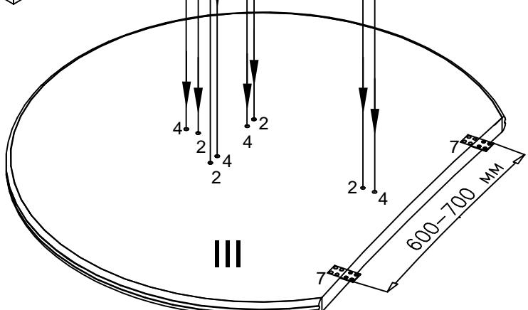
К средней панели прикрутить крепёжные уголки (8) с помощью винтов (9). Установить и прикрутить приставку к столешнице и боковине стола.
