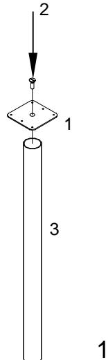
Положить столешницу, при необходимости сориентировав рисунок текстуры согласно дизайн-проекту расстановки столов, установить опору в требуемом месте (по оси симметрии столешницы) фланцем крепления вниз и закрепить 6-ю саморезами (4) (см. рис.2).
