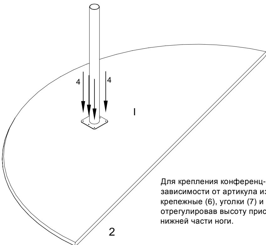
Для крепления конференц-приставки к столу или столам, в зависимости от артикула изделия, использовать пластины крепежные (6), уголки (7) и саморезы (5) предварительно отрегулировав высоту приставки при помощи регулируемой нижней части ноги.
