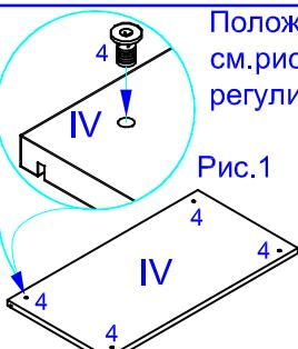
Положить полку нижнюю (IV) пазом вниз, см.рис.1. Забить в отверстия футерки опор регулируемых (4).
