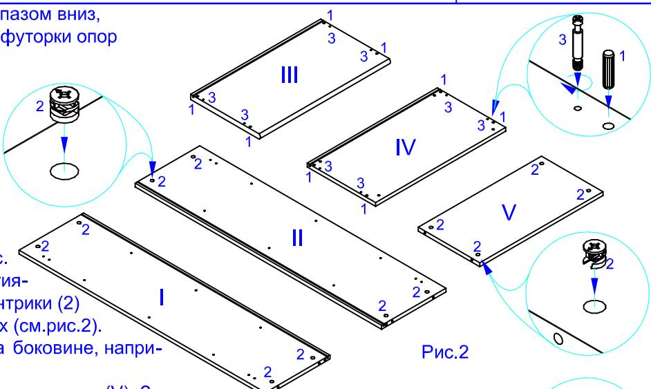
Вкрутить дюбеля стяжек-эксцентриков (3), вставить в отверстия шканты (1) (см. рис. 2). Положить переставные полки (V) отверстиями вверх, (см.рис.2). Вставить стяжки-эксцентрики (2) стрелкой в направлении отверстий на торцах (см.рис.2). Каркас стеллажа рекомендуется собирать на боковине, например левой (I), как показано на рис.3.
