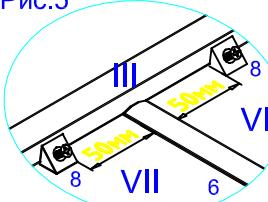
задних (VII) и соединительного профиля (6) установить уголки (8) на расстоянии 50мм от соединительного профиля (6) см.рис.5.
