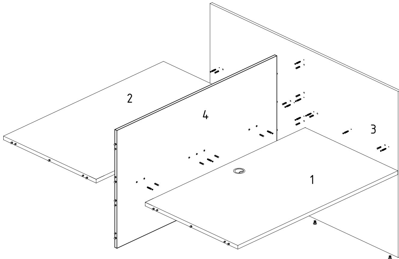
Вкрутить в боковину(3) дюбеля эксцентриков(б). Установить на боковину (3) опоры(д). Вбиты шканты в торцевую часть столешниц(1и2). Установить эксцентрики(а) в столешницы. Соединить столешницы (1и2) с экраном(4) на двойной дюбель. Соединить конструкцию из столешниц (1и2) и экрана (4) с боковиной(3). Затянуть эксцентрики(а). Установить на столешницы заглушки(е).
